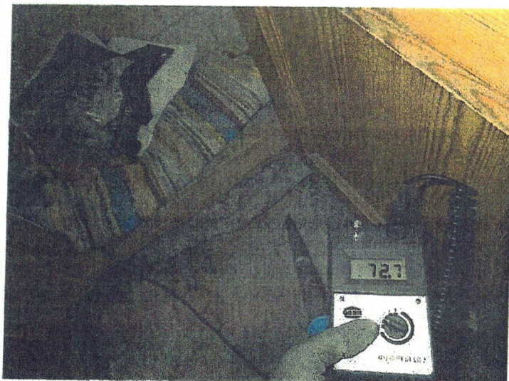
Eteistilan mittausta. Pesuhuonetta kohti mentäessä arvot nousevat. Alaohjauspuu kostea käytävän puolella
